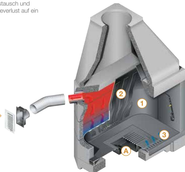
**BOCCHETTE USCITA ARIA CALDA** Tramite le bocchette poste sulla controcappa è possibile distribuire l'aria calda nel locale dove è installato il camino o nella stanza attigua (solo nella serie C).
